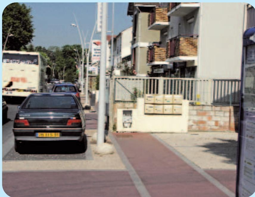
> Être décalée du stationnement longitudinal, d'un mur ou d'un grillage d'au moins 30 cm au mieux 50 cm (effet de paroi).
